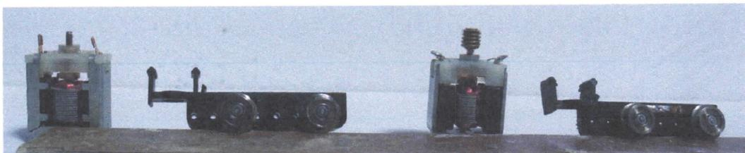
Es gibt zwei Generationen von Motoren und passenden Getriebeblöcken. Im Bild sind die jeweils passenden Paare zu sehen. Um den linken Motor in den rechten Getriebeblock einzupassen, entfernen Sie bitte die beiden unteren Nasen mit einer Nadelfeile. Die oberen Haken müssen unbeschädigt bleiben um den Motor sauber zu fixieren.
